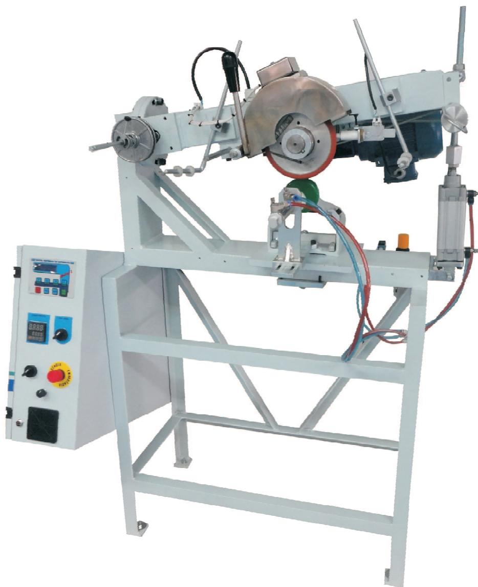
Termoimpressora contínua eletropneumática com rolo de silicone aquecido, sistema ROLL-ON contra mandril, específica para gravar peças cilíndricas.
