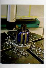
delo TM 200, usada para abertura de rasgos internos e externos. Possui curso de 200 mm e mesa para peças com diâmetro máximo de 450 mm.
